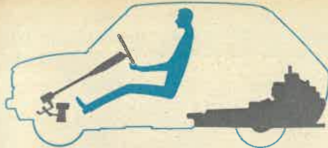
Minime condizioni di peso in esercizio: vettura parzialmente rifornita (metà serbatoio carburante) e solo guidatore: kg 650 dei quali 270 kg (41,5%) all'avantreno e kg 380 (58,5%) al retrotreno. Distanza minima da terra 13,5 cm (traversa fondo scocca).
