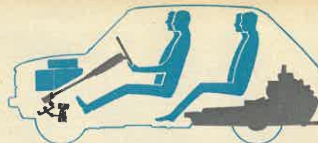
Massime condizioni di peso in esercizio: vettura completamente rifornita, 4 persone a bordo e kg 40 di bagaglio: kg 910 dei quali kg 375 (41,2%) all'avantreno e kg 535 (58,8%) al retrotreno. Distanza minima da terra 11,5 cm (traversa fondo scocca).
