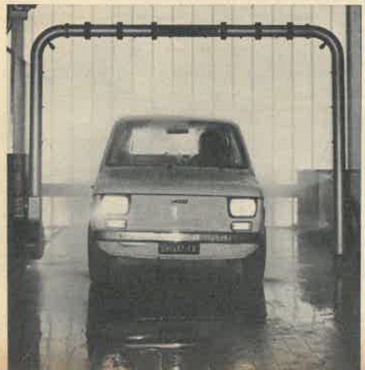
Tenuta acqua: infiltrazioni dai deflettori e dal lunotto posteriore.
