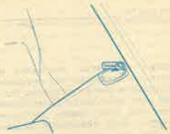
La levetta che comanda e regola il riscaldamento posta sul tunnel, vicino al sedile posteriore.
