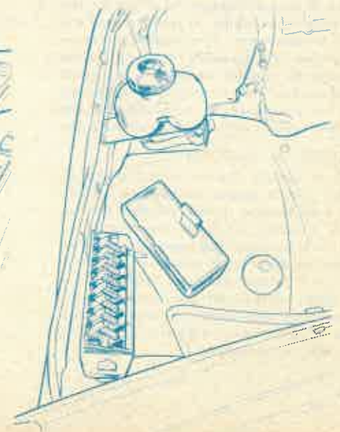
Il serbatoio olio per i due circuiti idraulici dei freni (0,35 kg) e la scatola porta fusiibili posti nel vano bagagli anteriore.
