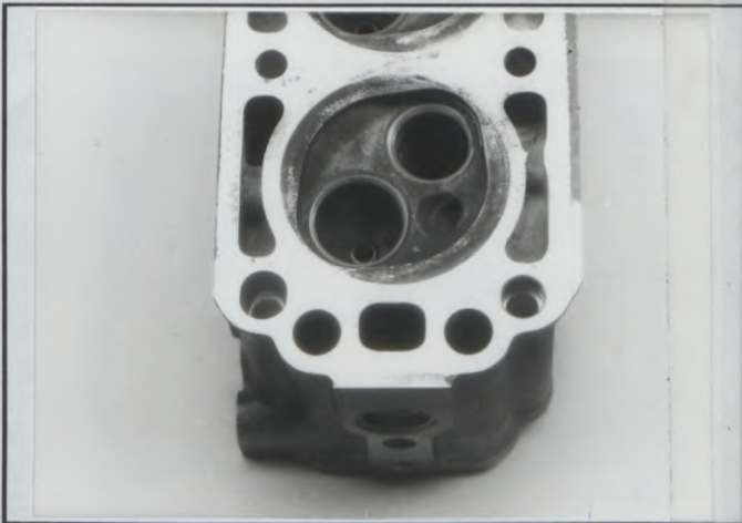
G) Verbrennungsraum Combustion chamber
